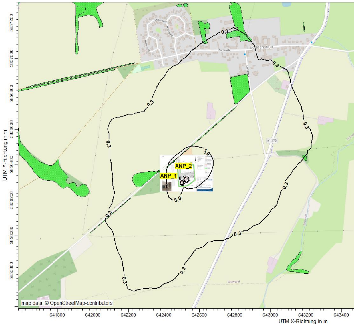
Abbildung 9: Stickstoffdeposition: Gesamtzusatzbelastung IGZ durch den Betrieb der Biogasanlage in \text{kg}/(\text{ha} \cdot \text{a}) , n(\text{meso})\text{-dep} (gültig für Mesoskala)
